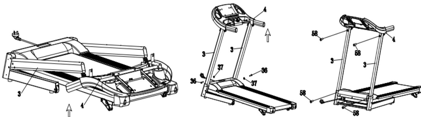
Шаг 3: Как показано на рисунках ниже: закрепите консоль (№40) на подставке (№4) с помощью крестообразных винтов ST4.2 \* 19 (№44). После этого соедините провода А и В и поместите ключ безопасности (№18) на желтую зону с передней стороны консоли.
